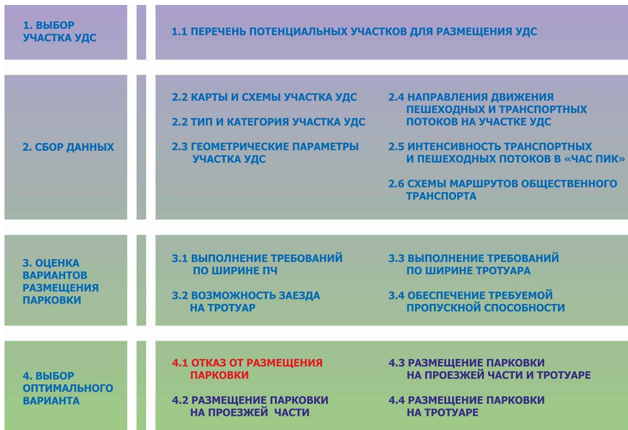
Рисунок 63. Алгоритм размещения парковок на УДС
