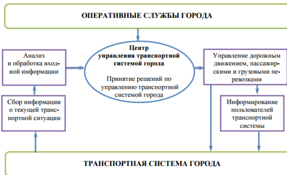
Рисунок 40. Пример схемы рабочих процессов Центра управления
