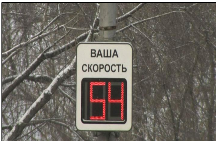
Рисунок 17. Пример дорожного знака обратной связи с водителем
